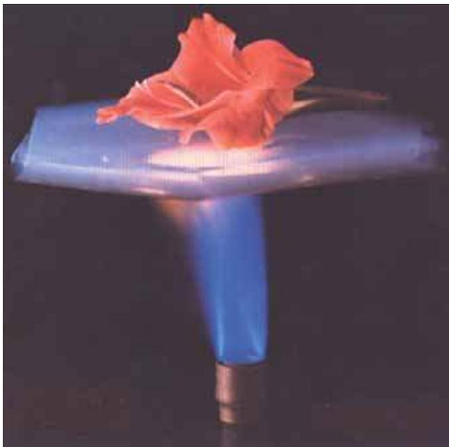
**Un fiore posto su un sottile strato di Aerogel a sua volta posto sopra una fiamma. Si noti come il fiore non subisce alcun effetto di riscaldamento della fiamma.**
