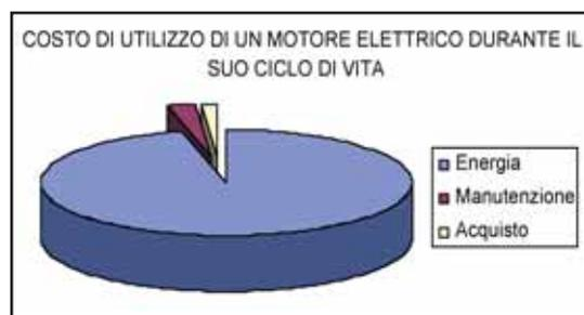
Far funzionare un motore durante il suo ciclo di vita costa, quindi, quasi 100 volte più che acquistarlo e parte dell'energia impiegata viene dispersa sotto forma di calore, vibrazioni, rumore. Queste perdite sono a loro volta causa di altri problemi: il calore deve essere disperso, causando un carico aggiuntivo al sistema di raffreddamento, calore e vibrazioni hanno un impatto negativo sui costi di manutenzione del motore e del sistema di trasmissione.
