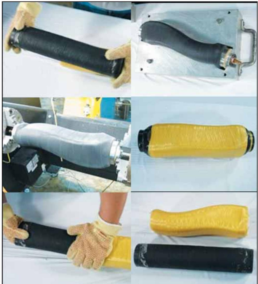
**Diverse fasi nell'utilizzo di un tubo in materiale a memoria di forma unidirezionale per la formatura di pezzi in composito (CRG Industries, USA)**
